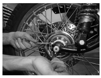
**Step 3**Loosen the axle pinch bolt.
